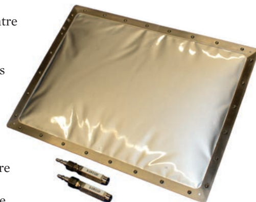
Sachet étalon avec fuites calibrées 3 et 11 microns
